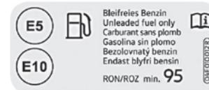
Tout carburant contenant jusqu'à 10% du volume en éthanol peut être utilisé (E5, E10).
